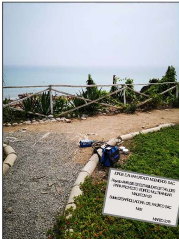
Foto N° 08: Investigación geofísica mediante medición de microtremores o vibraciones ambientales. Vista del punto M-03.
