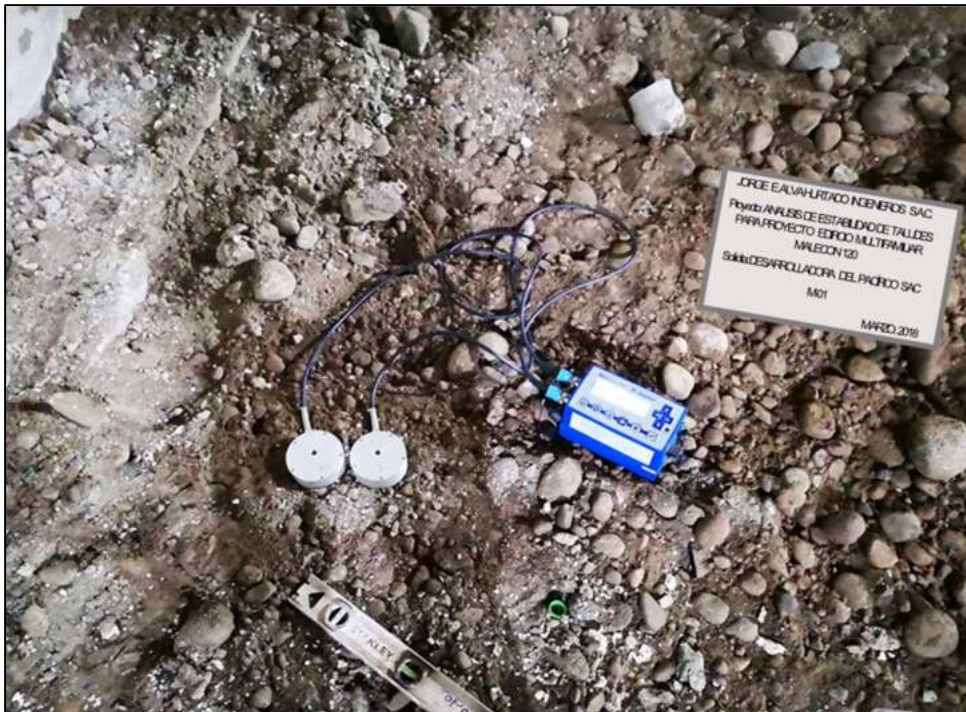
Foto N° 06: Investigación geofísica mediante medición de microtremores o vibraciones ambientales. Vista del punto M-01.
