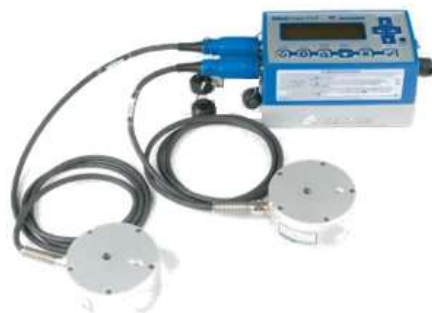
Imagen N° 6. Unidad Minimate Pro6 y sus Geófonos Triaxiales
